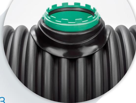
Awadock CP est la solution rapide et fonctionnelle pour le branchement d'un tube lisse DN 160 ou 200 sur un tube annelé de diamètre DN/OD 400 à DN/OD 1200. Avec seulement trois variantes l'Awadock CP, de par sa polyvalence, est utilisable sur la majorité des tubes conformes à la NF EN 13476-3. Le branchement demeure durable, sûr et étanche à la pression.
