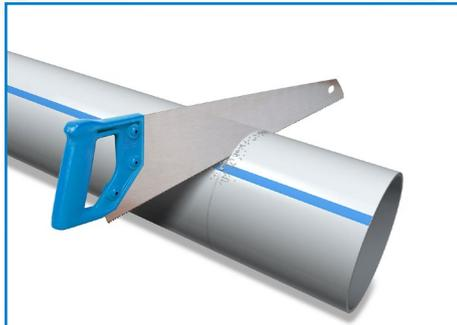
Oter les bouchons de protection des extrémités du tube. Couper le tube, au besoin, à la scie ou à la meule rotative, suivant un plan perpendiculaire à l'axe du tube.
