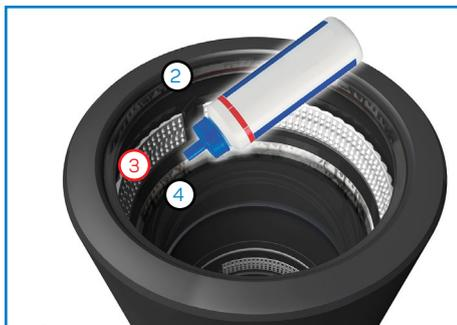
Sortir le manchon de son emballage et ôter les bouchons de protection. Enduire suffisamment de lubrifiant la bague d'étanchéité résistant à la pression (4) et puis modérément le joint racler anti-salissures (2). Attention, ne pas mettre de lubrifiant sur le cerclage PVC avec grips inox (3).
