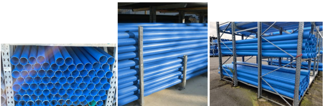
Figure 3 – Exemples de bonnes pratiques de stockage de tubes dépalettisés
